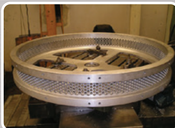
PENEIRA EM ALUMÍNIO CENTRIFUGADO
