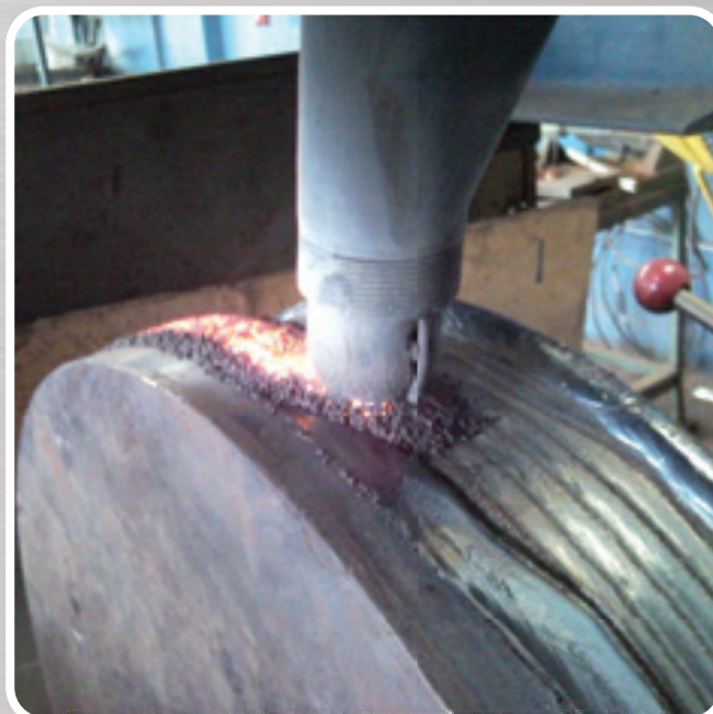
PROCESSO METALIZAÇÃO AUTOMÁTICO
