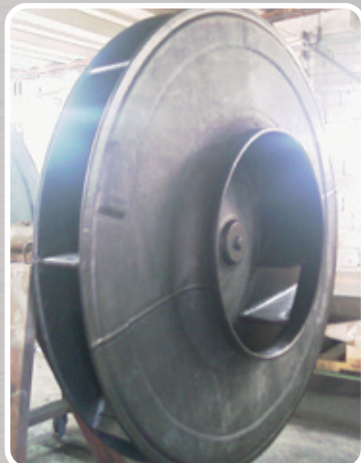
ROTOR REVESTIDO EM BUNA "N"
